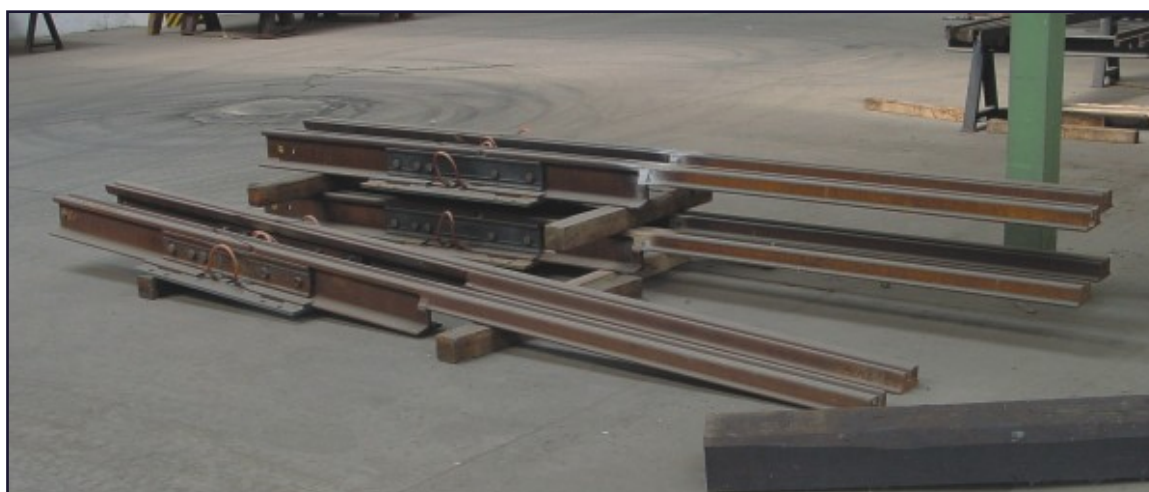
Přechodové kolejnice s vloženou dilatační kolejnicí
