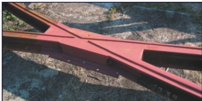
Speciální srdcovka s funkční částí z ořezuvzdorného plechu HARDOX® 450
